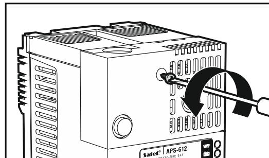
2. Снимите защиту клемм блока питания.
