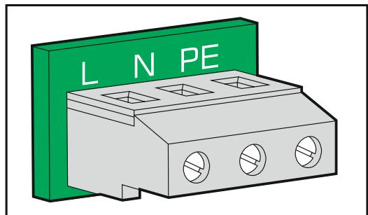
10. Прикрутите элемент, предназначенный для крепления проводов.
