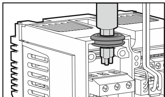
9. Подключите провода питания 220 В AC к соответствующим клеммам: фазный проводник (фаза) – к клемме L, нулевой рабочий проводник (ноль или нейтраль) – к клемме N, нулевой защитный (земля) – к клемме PE.
