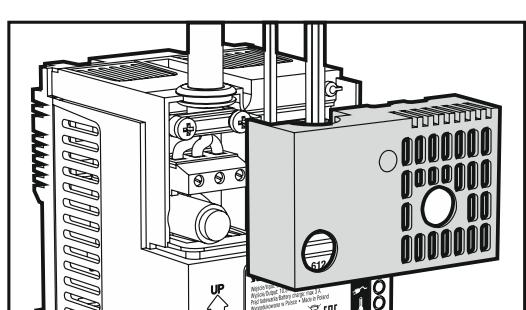
12. Вкрутите шуруп, крепящий защитную коробку клемм блока питания.
